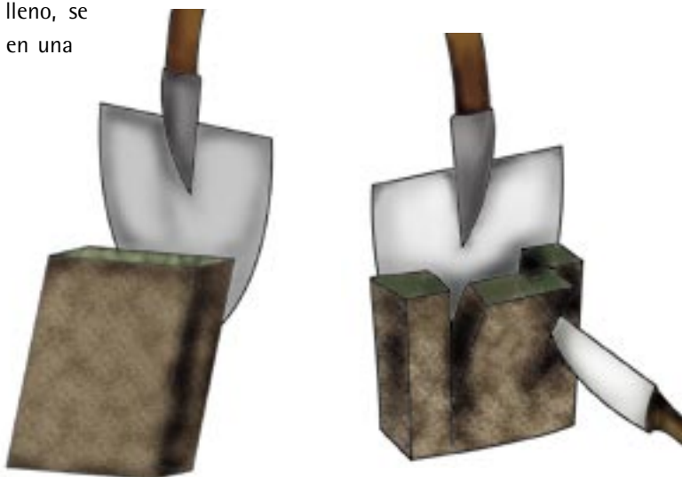
Figura 4: Esquema de muestreo con pala
