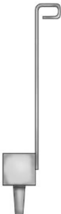
Figura 5: Muestreador de capa arable.
